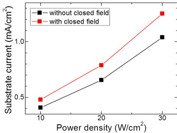
Fig. 5 基板電流の投入電力依存性
