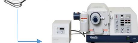
接合部を-30°C以下に冷却しつつ切削。はんだ、樹脂等の熱ダメージに弱い材料の接合界面観察準備に適しています。
