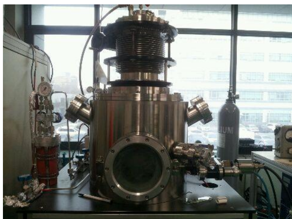
図.5 使用した PECVD 装置
